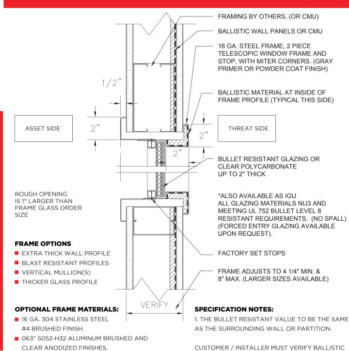
RAY-BAR TELESCOPIC BALLISTIC WINDOW FRAME UL8
