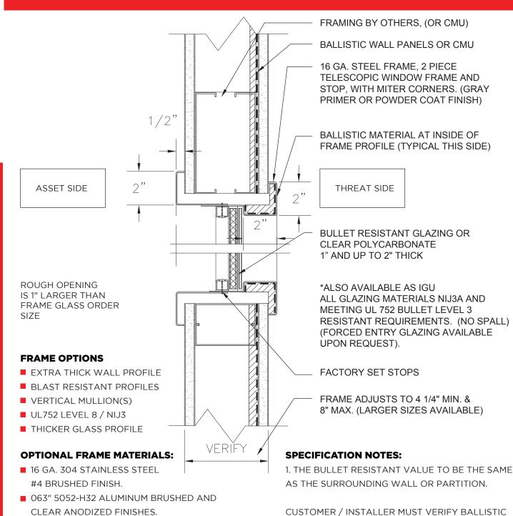
RAY-BAR TELESCOPIC BALLISTIC WINDOW FRAME UL3
